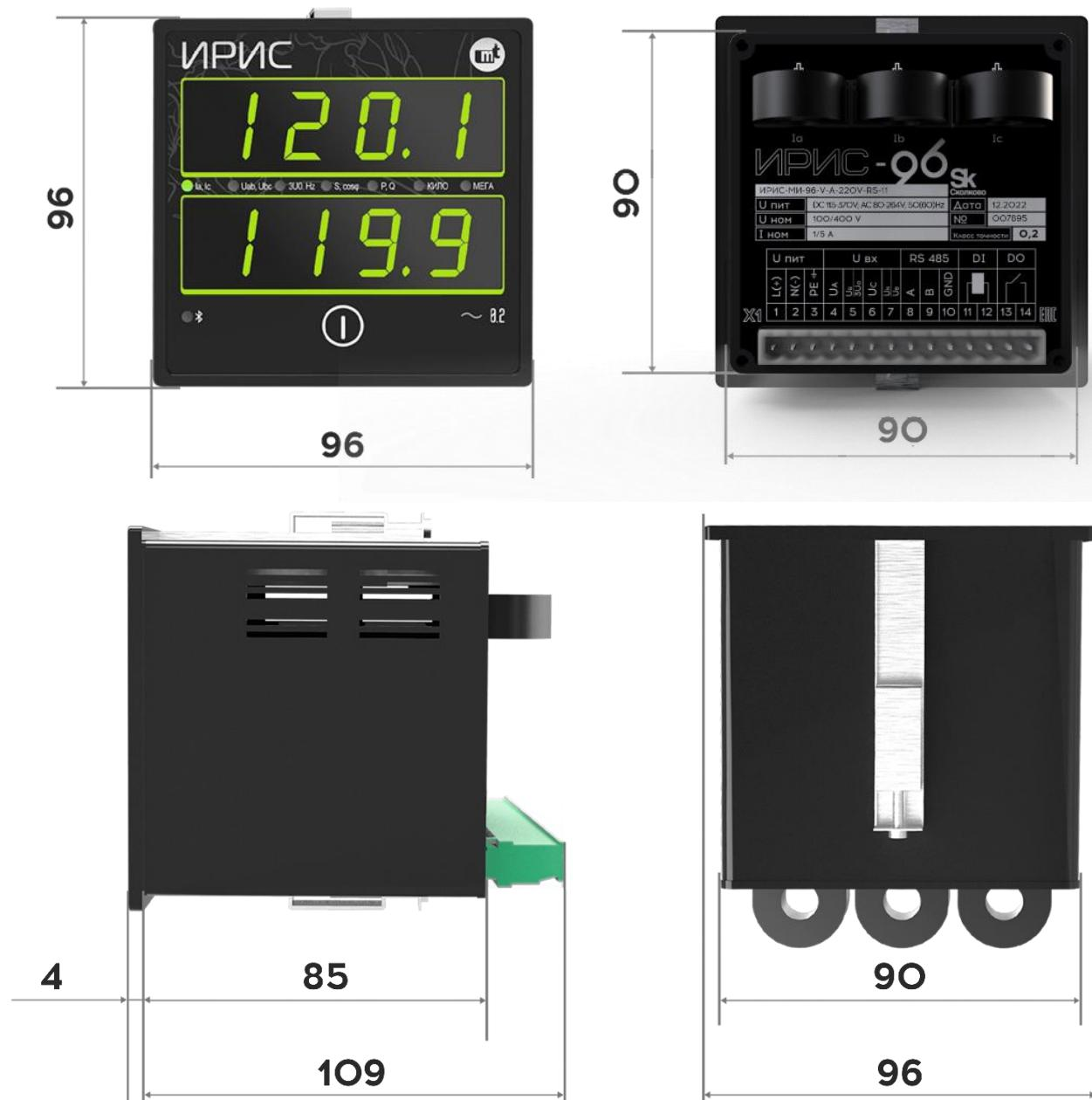
РАЗМЕРЫ ВЫРЕЗА НА МОНТАЖНОЙ ПОВЕРХНОСТИ – 92x92 мм
