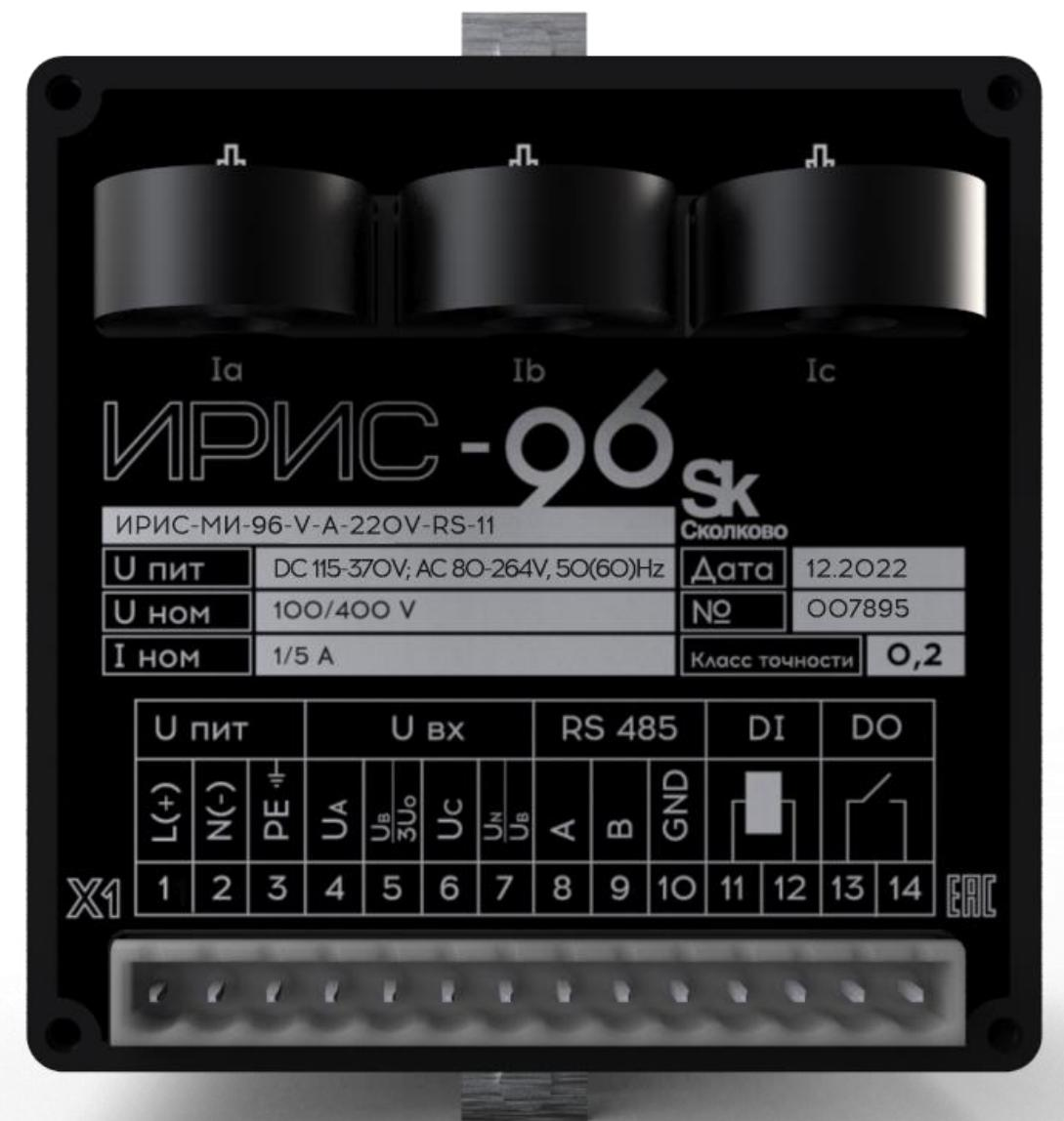
Рисунок 2.3 - Внешний вид задней панели ИРИС
