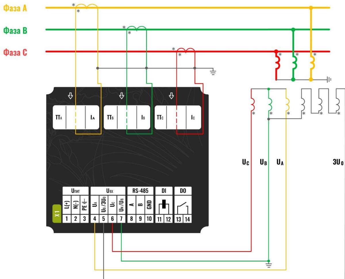
**Рисунок 10.6 - Схема подключения устройства с внешними трансформаторами тока и трансформаторами напряжения с дополнительной обмоткой (ЗТТ, ЗТНД)**
