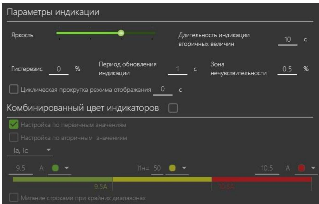
Рисунок 4.1 – Параметры и настройки цветности индикации
