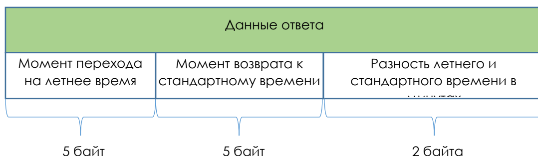
Рисунок 7. Поле данных положительного ответа на запрос чтения параметров летнего времени
