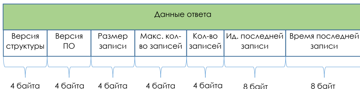
Рисунок 16. Поле данных положительного ответа на запрос чтения информации о конкретном журнале
