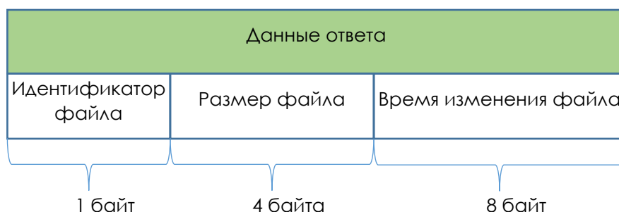
Рисунок 32. Поле данных положительного ответа на запрос открытия файла для доступа в сжатом виде
