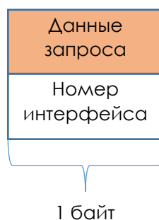
Рисунок 42. Структура запроса чтения конфигурации интерфейса RS-485
